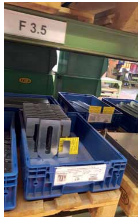
Wird Material in der Montage verbraucht, wandern nun gelbe Karten mit der Bezeichnung der Teile in die Blechfertigung.
