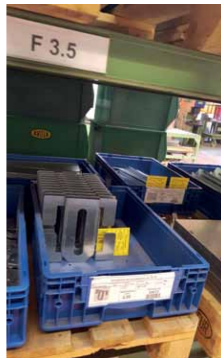
Wird Material in der Montage verbraucht, wandern nun gelbe Karten mit der Bezeichnung der Teile in die Blechfertigung.
